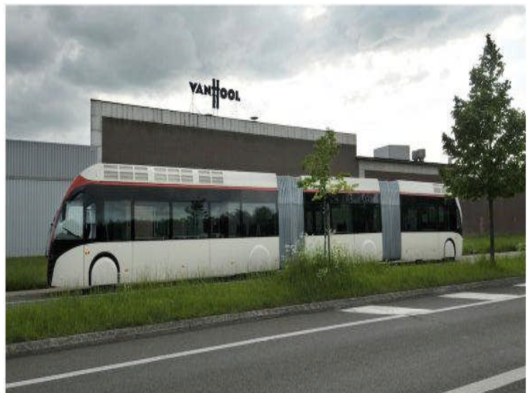
Der 24-Meter lange zweigelenkige Van Hool Biogashybridbus.
